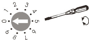
Abb.: Einstellen des Funkkanals.
