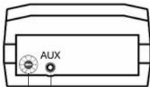
Anschluss für Vibrationskissen und Module (Sonderzubehör)
